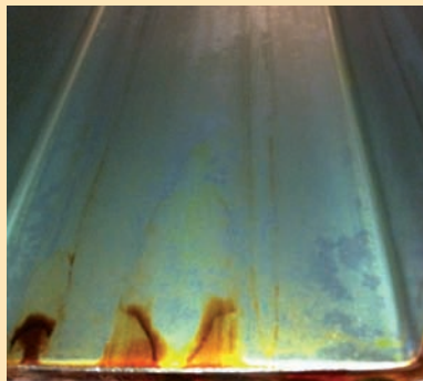
Viskose Prozesslösungen wie im Verchromungsprozess führen zu raschem Aufkonzentrieren der Sparspülen und zu fleckigen Rückständen.
