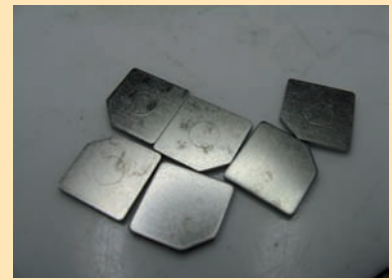
Spülfehler durch unzureichende Wasserqualität und -quantität werden häufig erst nach der Teiletrocknung oder gar erst bei Einsatz des Teiles sichtbar.
