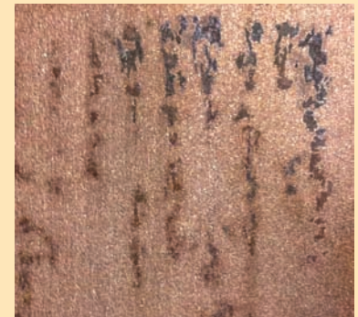
Wird der Heizprozess durch die Spülung nicht ausreichend schnell gestoppt, kann die Oberfläche Schaden nehmen.
