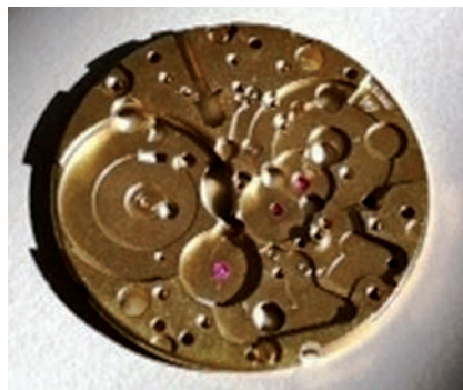
In der Uhrenindustrie bergen zahllose feinste Bohrungen und zusammengesetzte Schwungmassen eine hohe Verschleppungsgefahr.
