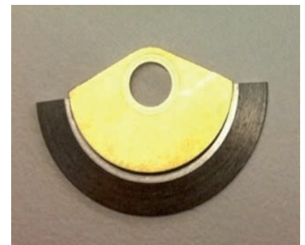
In der Uhrenindustrie bergen zahllose feinste Bohrungen und zusammengesetzte Schwungmassen eine hohe Verschleppungsgefahr.
