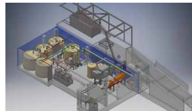
Installation de traitement des eaux résiduaires après traitement de surface par voie humide. Capacité de 40 m 3 /jours, totalement automatisée
