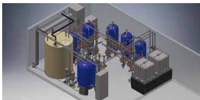
Echangeur d'ions pour la recirculation des eaux de rinçage d'une chaîne de déposition de métaux précieux. Débit 18 m 3 /h, totalement automatisée.
