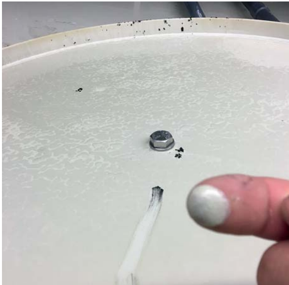
Durch UV-Strahlung löste sich dieser Behälter aus PP auf
