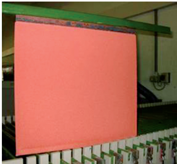
Bild 1: Abgeschiedenes Kupfer auf Kupferblech-Kathode
